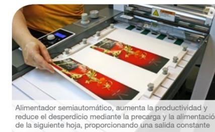
Alimentador semiautomático, aumenta la productividad y reduce el desperdicio mediante la precarga y la alimentación de la siguiente hoja, proporcionando una salida constante
