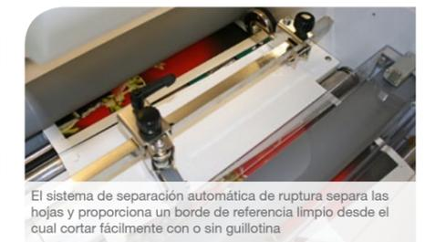
El sistema de separación automática de ruptura separa las hojas y proporciona un borde de referencia limpio desde el cual cortar fácilmente con o sin guillotina
